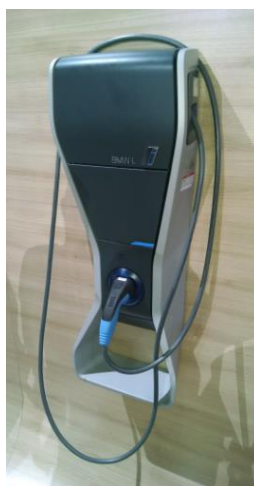
Figura 13–Instalação de Recarga Residencial BMW
