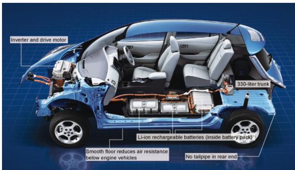
Figura 10– Sistema de Transmissão do Leaf Fonte: LENZ (2012)
