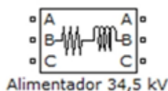
Figura 30 - Representação do circuito trifásico do alimentador no SimPowerSystems. Fonte: The Mathworks , 2011.
