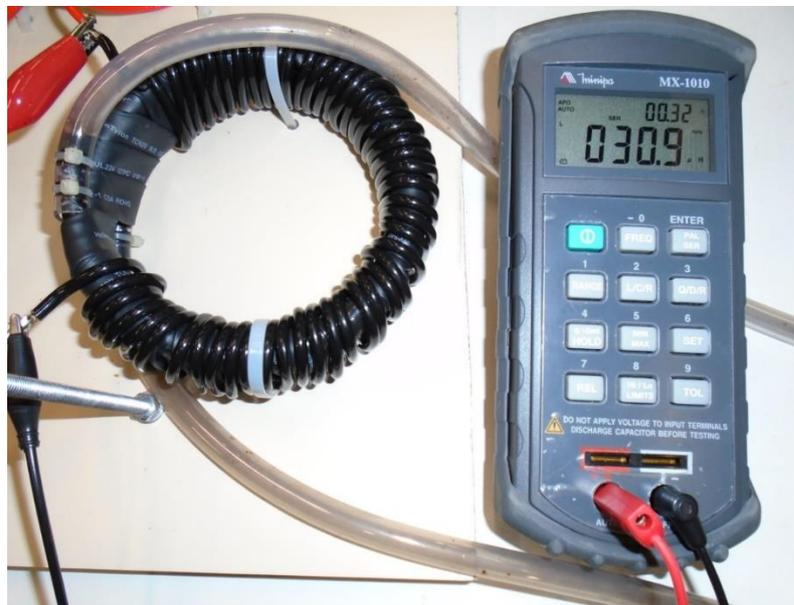
Figura 38 – Ponte RLC medindo o indutor
