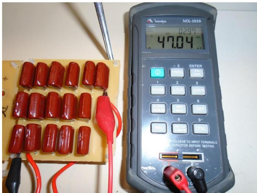
Figura 39 – Banco de capacitores para a carga
