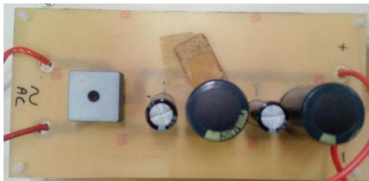
Figura 32 – Placa montada do retificador com filtro capacitivo
