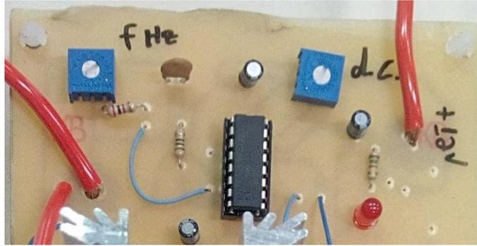
Figura 34 – Placa montada do oscilador com SG3525
