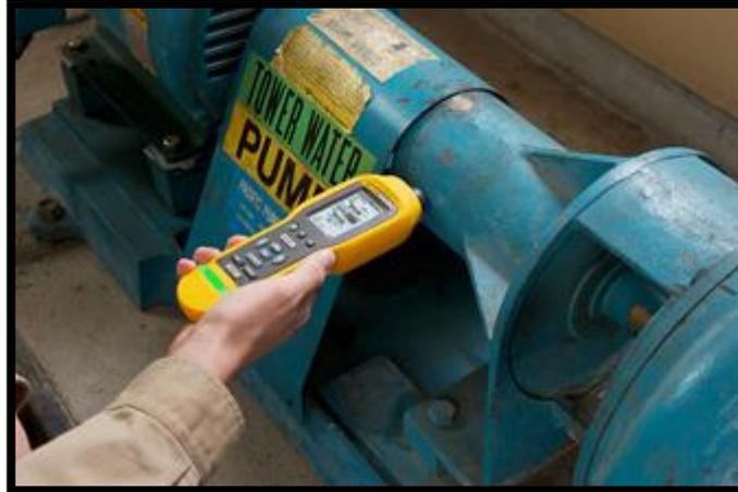
**Figura 12: Vibrômetro sendo utilizado em uma bomba de selo mecânico**
