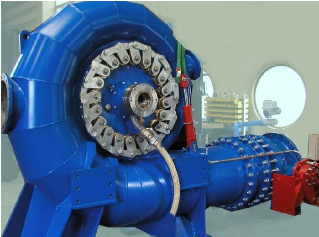
Figura 3 - Turbina Francis convencional. Fonte: Global Hydro , 2010.
