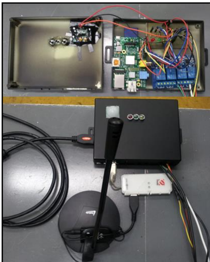
Figura 30 - Sistema de reconhecimento de voz na caixa plástica Fonte: Autoria própria.
