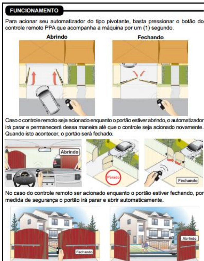
Figura 29 - Funcionamento do motor do sistema de portão eletrônico PPA Fonte: PPA (2013).
