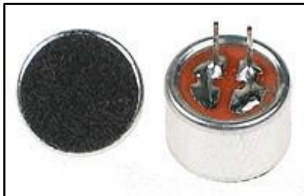
Figura 10 - Microfones de eletreto Fonte: Patsko (2006, p. 25).
