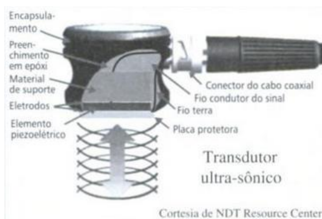
Figura 2.7 Transdutor ultrassônico. Fonte: FAWWAZ,2005 p.189
