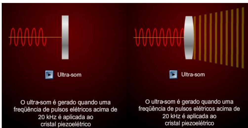
Figura 2.6 Cristal piezoelétrico gerando ultrassom. Fonte: (Hermes Prado Jr,MD) http://artesmedicas.com/piezoeltricidade.htm
