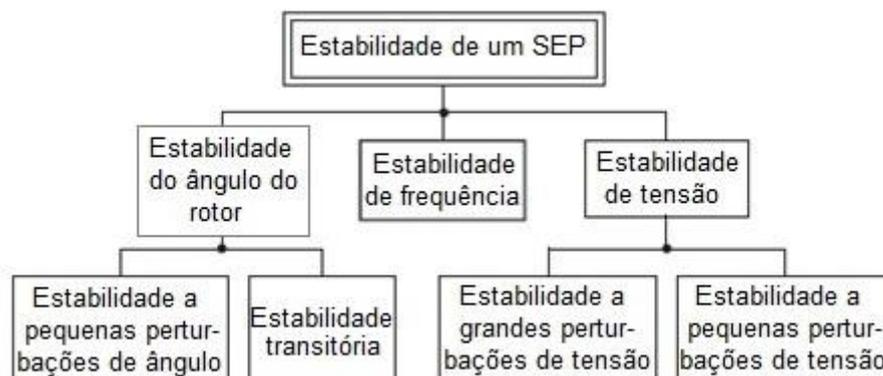
**Figura 2 – Classificação da estabilidade de um sistema de potência**
