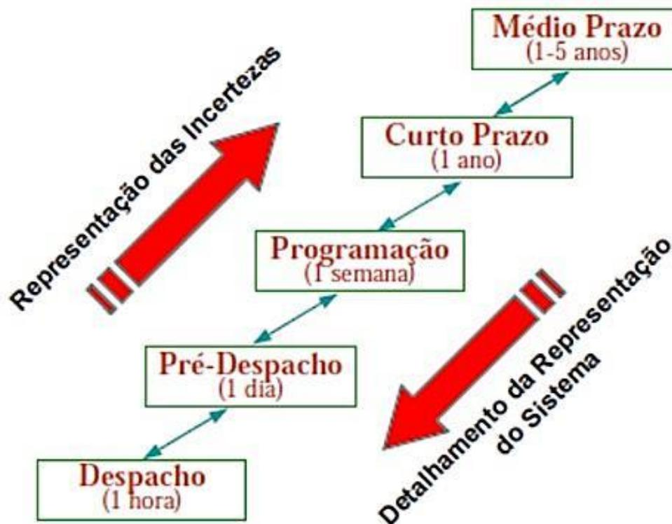
**Figura 1 - Modelos Temporais do Planejamento da Operação Energética de Sistemas Hidrotérmicos**
