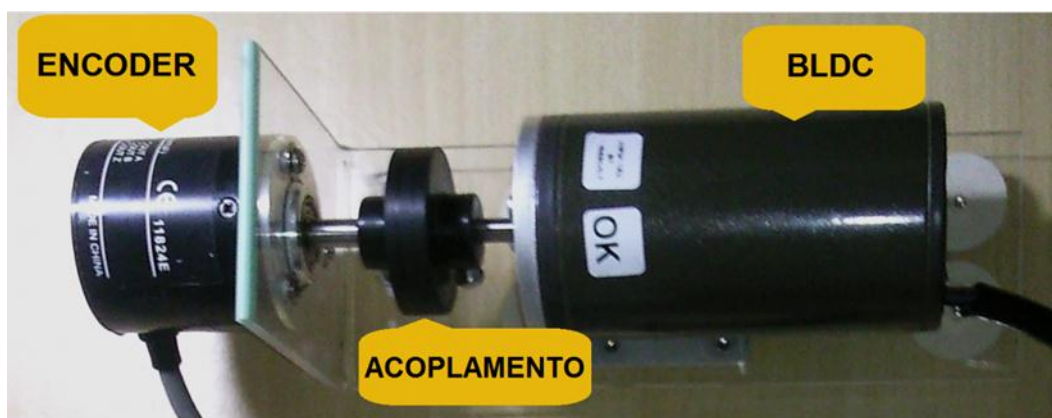
Figura 3 - Sistema para leitura de velocidade
