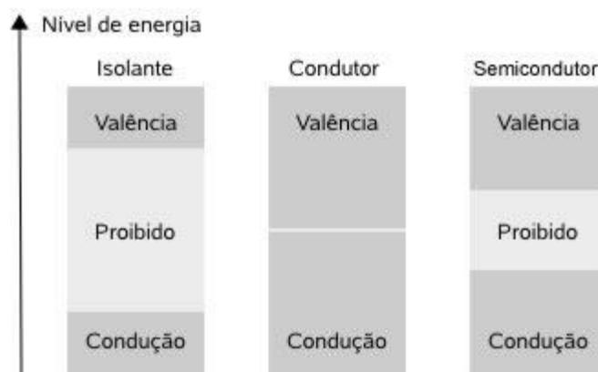
**Figura 3 – Bandas de Valência, banda proibida e banda de condução de: Isolantes, condutores e semicondutores**
