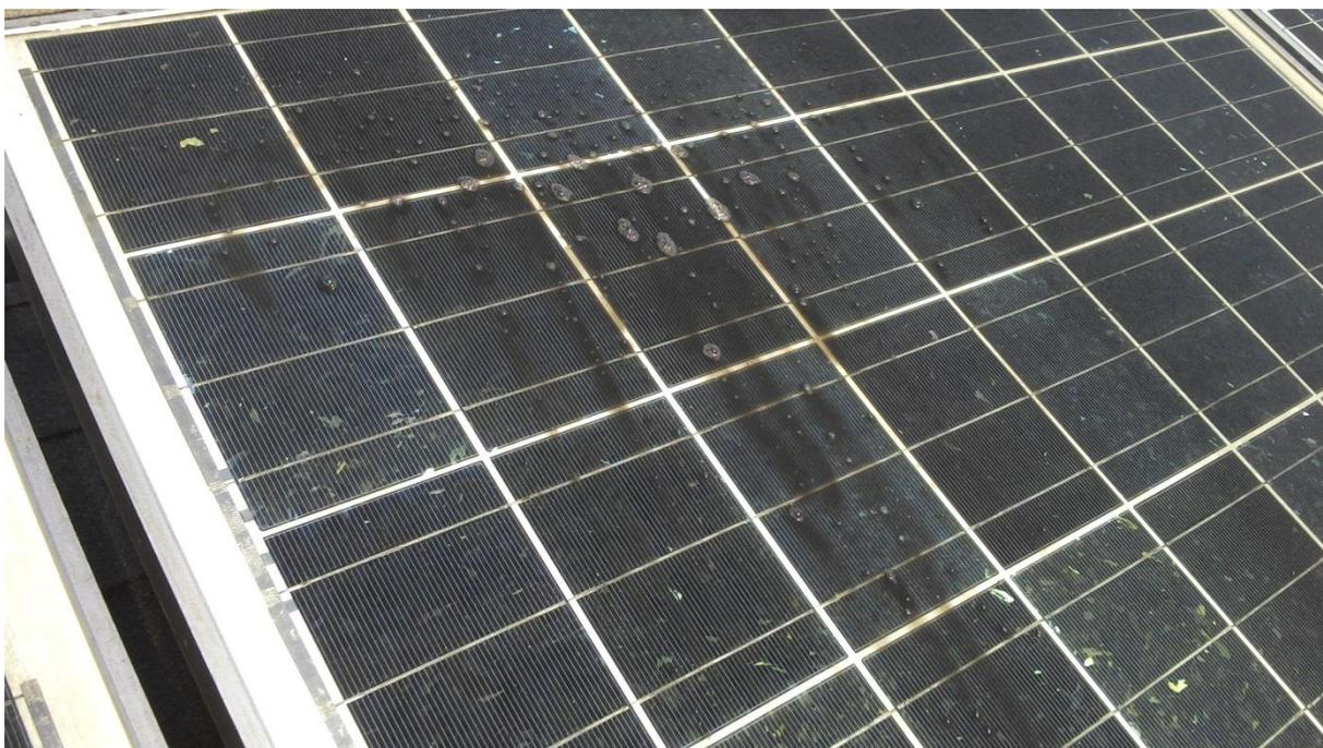
**Figura 24 – Foto da sujeira acumulada sobre o módulo fotovoltaico**
