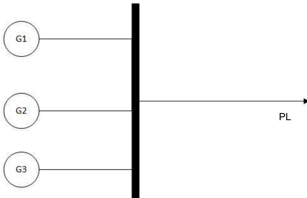
Figura 6: Sistema de 3 geradores a ser simulado para obter o resultado do DE.
