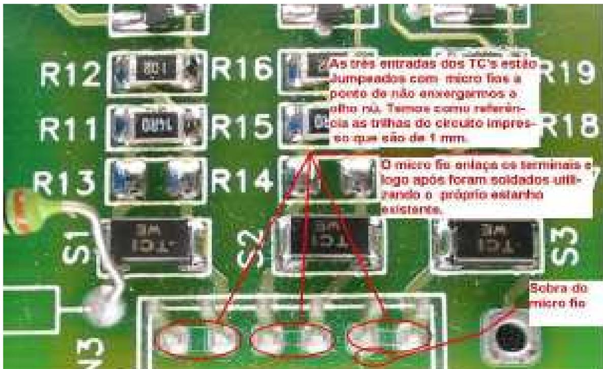
Figura 27 - Entradas de Tc's jumperadas na placa do medidor eletrônico
