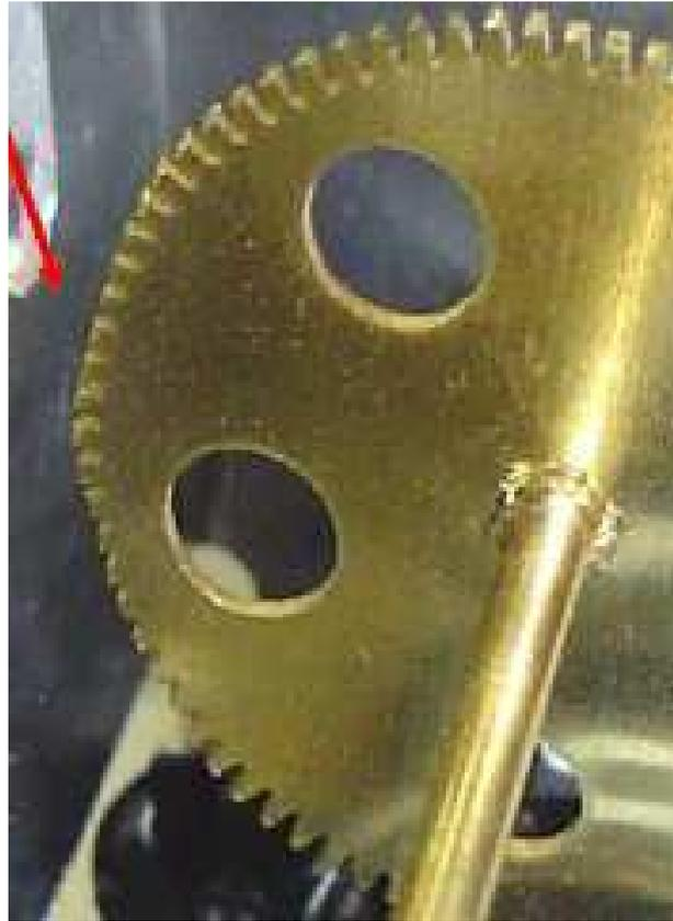
**Figura 58 - Raspagem na engrenagem do medidor**
