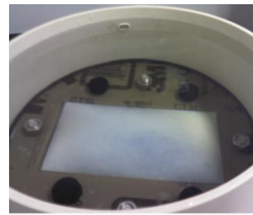
Figura 20: Placas de acrílico com pericárdio submerso em solução dentro do dispositivo. (Fonte: Próprio autor)
