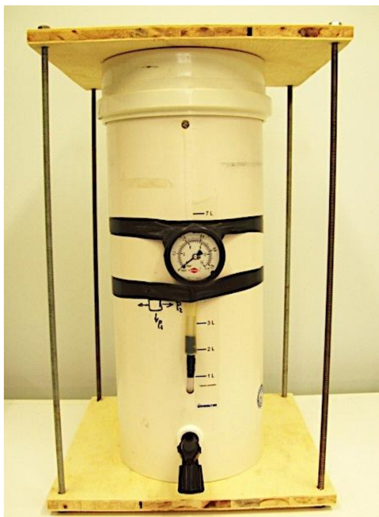
Figura 21: Dispositivo utilizado para moldagem do PB sob pressão (Fonte: próprio autor)
