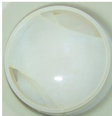
Figura 16: PB nos bastidores submersos em solução de GDA (Fonte: Próprio autor)
