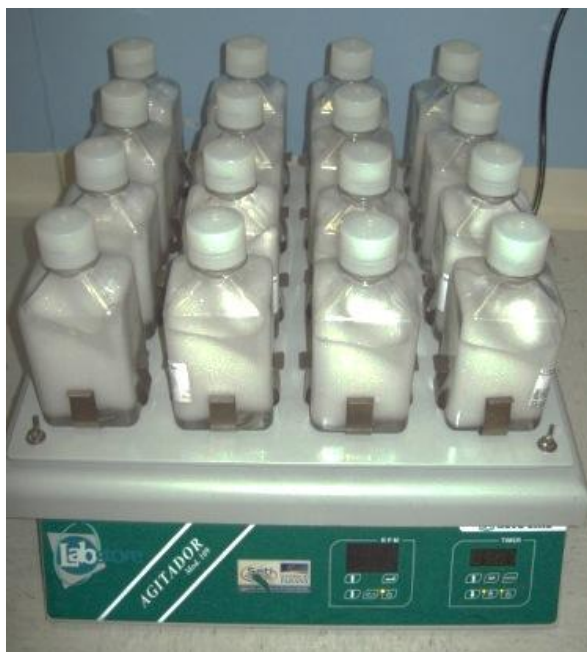
Figura 17: PB nos frascos com solução de SDS e EDTA no agitador Nova Ética – mod. 109. (Fonte: próprio autor)
