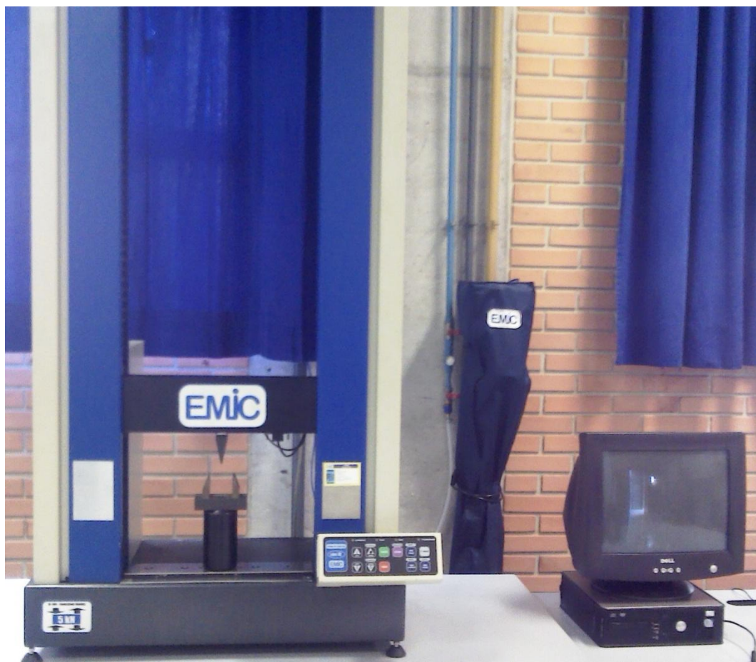
Figura 26: Máquina universal EMIC DL – 500 (Fonte: Próprio autor)
