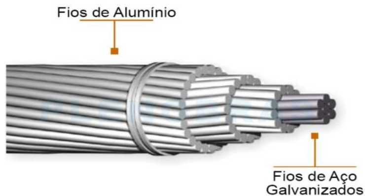
Figura 4.3 - Cabo condutor encordoado de alumínio com alma de aço (26 Al – 7 Aço) Grosbeak 636 MCM. Fonte: Alubar (2010).
