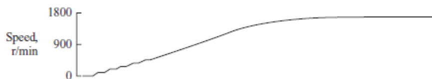
Figura 34: Velocidade simulada pelo modelo do krause para a máquina 1 com conjugado nulo.
