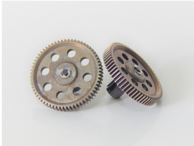
Figura 31 – Fixação do eixo na engrenagem
