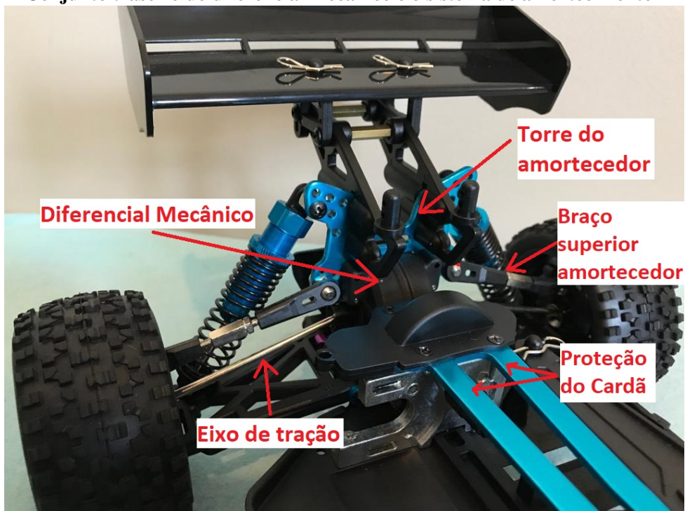
Figura 14 – Conjunto traseiro do diferencial mecânico e o sistema de amortecimento
