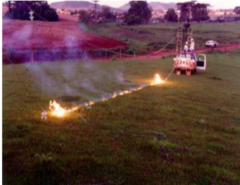
FIGURA 10: Curto-circuito fase terra sobre grama
