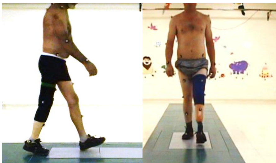
Figura 5 – Disposição dos marcadores reflexivos de acordo com o Modelo Helen Hayes. À esquerda, vista sagital. À direita, vista anterior
