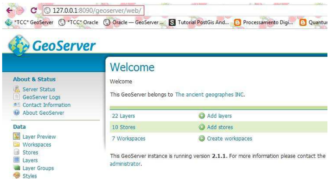
Figura 20: 127.0.0.1 - localhost e 8090 - porta alterada (Fonte: BURAKOSKY; Juliane Roncovsky, 2011)
