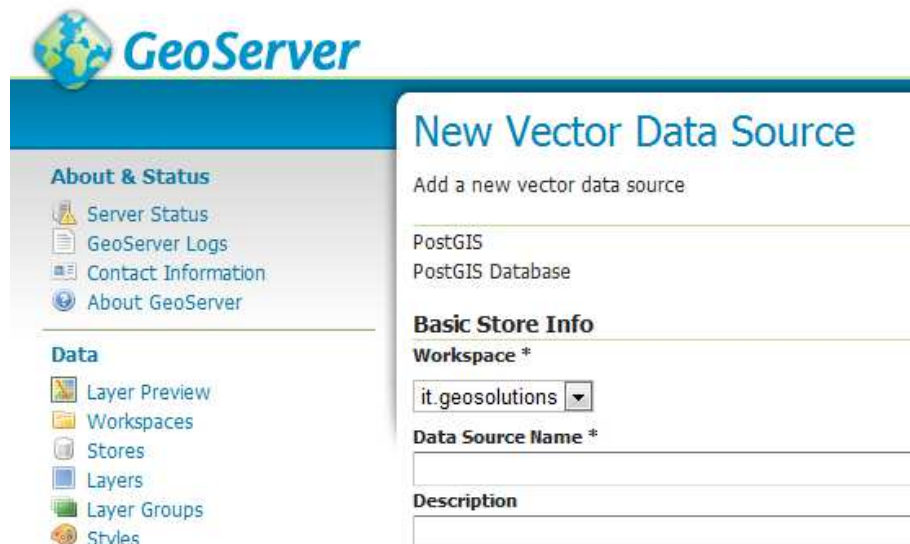
Figura 21: Opção "New Vector Data Source" utilizada para configurar a conexão com o com o PostGIS (Fonte: BURAKOSKY; Juliane Roncovsky, 2011)
