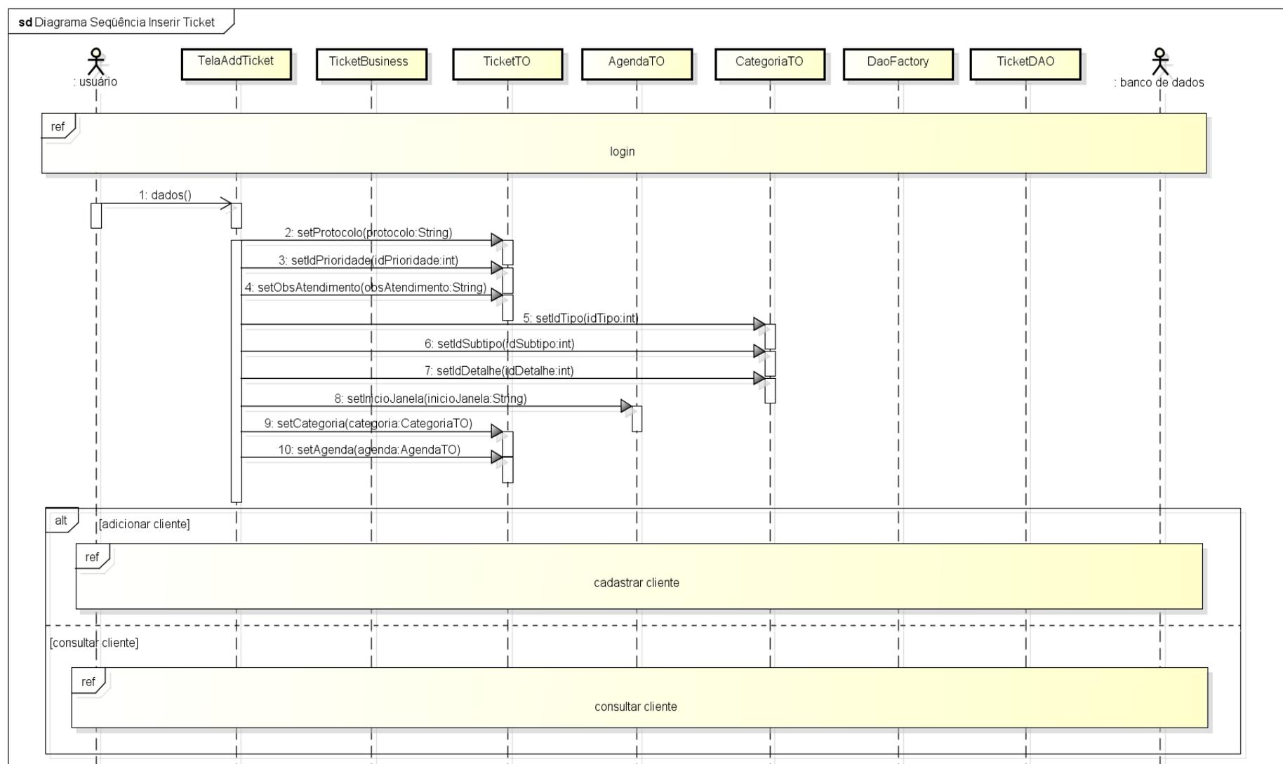
**Figura 8 - Parte 1: Diagrama de Seqüência Inserir Ticket**
