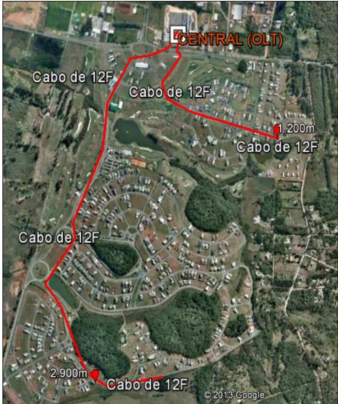
Figura 31 – Planejamento dos cabos Fonte: Autoria própria
