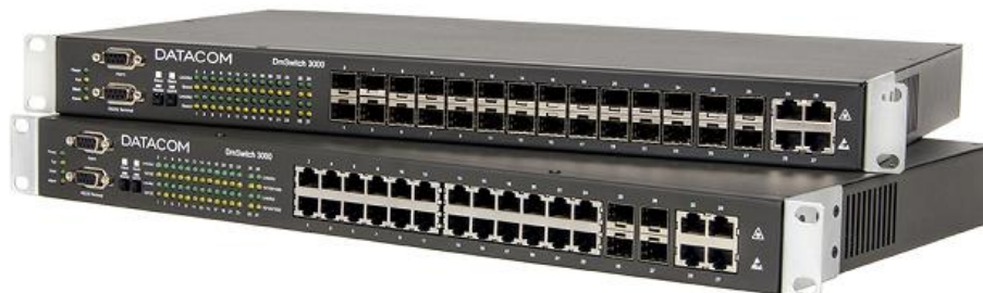
Figura 23 - Switch Metro Ethernet DM3000 Fonte: Datacom (2013).
