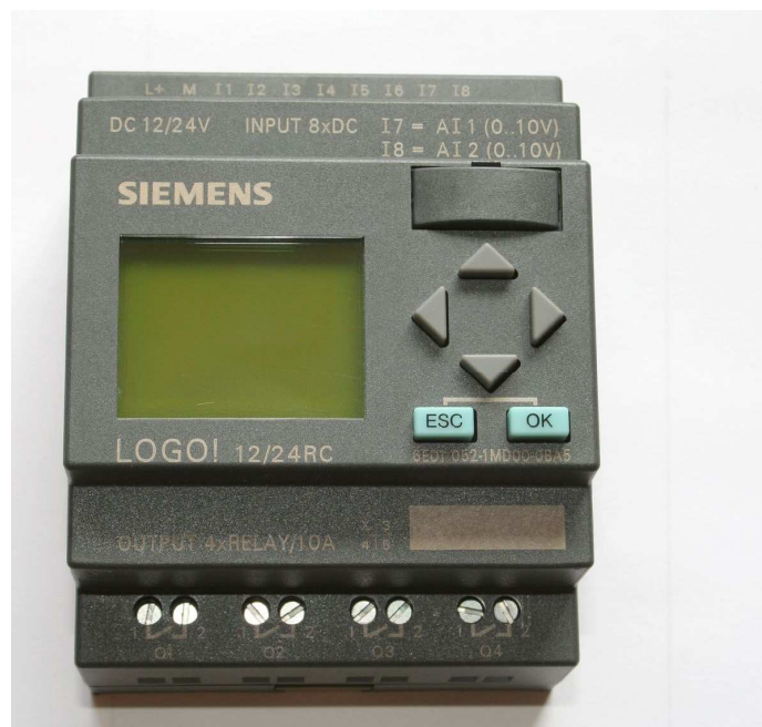
Figura 4: Controlador Lógico Programável Logo Fonte: Siemens
