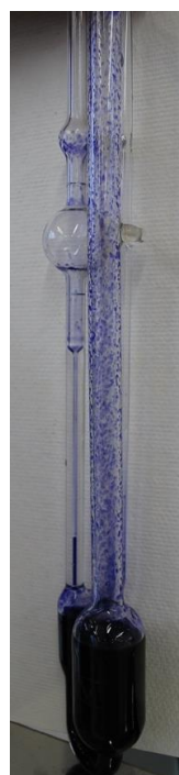
B- Pasta não branqueada, parede suja, retarda fluxo no capilar
