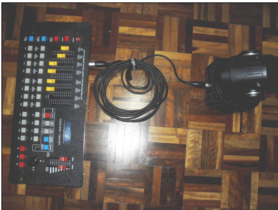
Fotografia 3 - Conexão DMX 512 entre controlador e dispositivo controlado Fonte: Autoria própria
