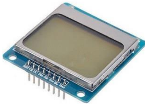
Figura 8 – Display Nokia 5110 LCD Fonte: Lima, 2015.
