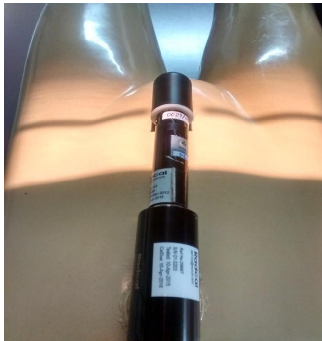
Figura 10 – Câmara de Ionização sobre simulador Médio (5 anos) Fonte: Autoria Própria.
