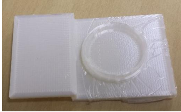
Figura 14 - Amostra recoberta por filme PVC no porta-amostra de PLA
