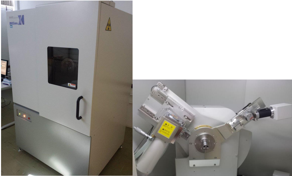
Figura 11 - Diffractômetro Shimadzu XRD-7000 externamente à esquerda e internamente à direita. Fonte: A autoria própria (2016).
