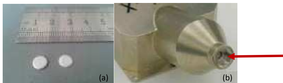
Figura 13 – Filtro de alumínio (Al). Em (a) são visualizados dois filtros de Al, um de 0,25 mm e o outro de 1 mm. E em (b) o tubo de raios X “aberto” no local onde foram inseridos os filtros de Al Fonte: Imagem adaptada Amptek (2014b).
