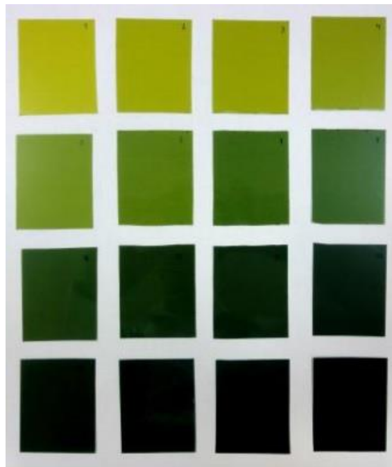
Figura 4 - Filmes radiocrômicos irradiados com aumento sucessivo de dose
