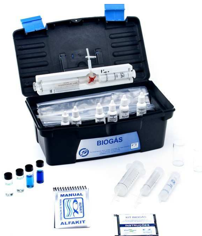
Figura 9. Foto do “Kit Biogás” utilizado para análise do biogás Fonte: Alfakit/Embrapa
