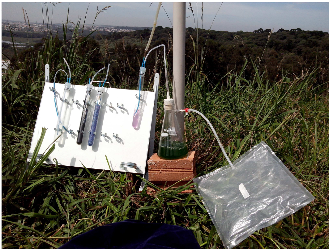
Figura 7. Foto do sistema de purificação combinando coluna de NaOH 3% seguido de cultivo de microalgas e demonstração do processo de coleta em bags .
