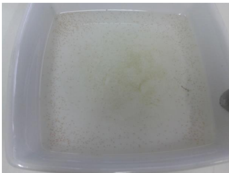
FIGURA 4. Bandeja com os organismos D. magna , filhotes que serão empregados nos ensaios ecotoxicológicos.
