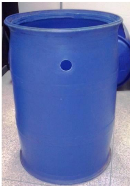
Figura 33 – Detalhe da furação para adaptação da tubulação de saída
