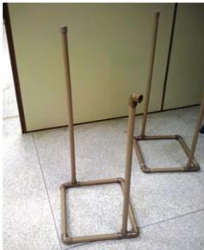
Figura 31 – Tubulação interna de saída do efluente
