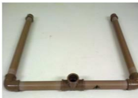
Figura 32 – Montagem da Tubulação interna de entrada
