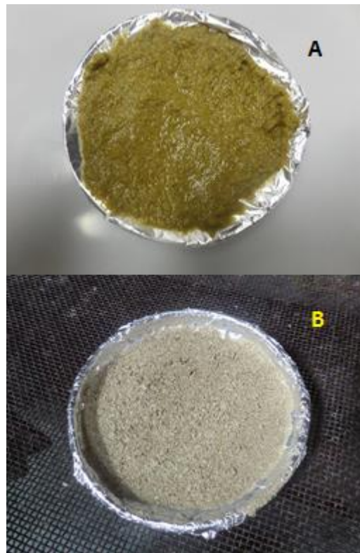
Figura 4: Levedura após a lavagem (A) e após a secagem (B).
