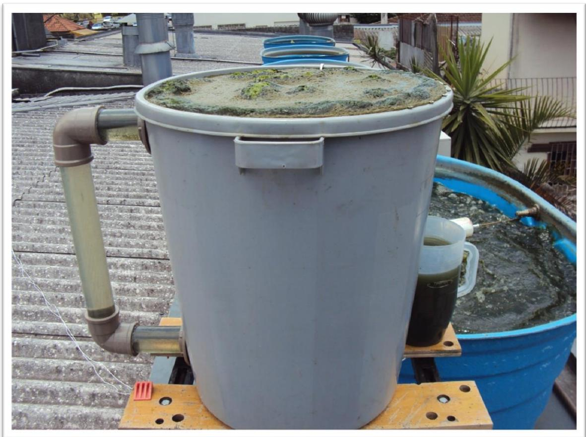
**Figura 10: Eletroflotador em funcionamento**
