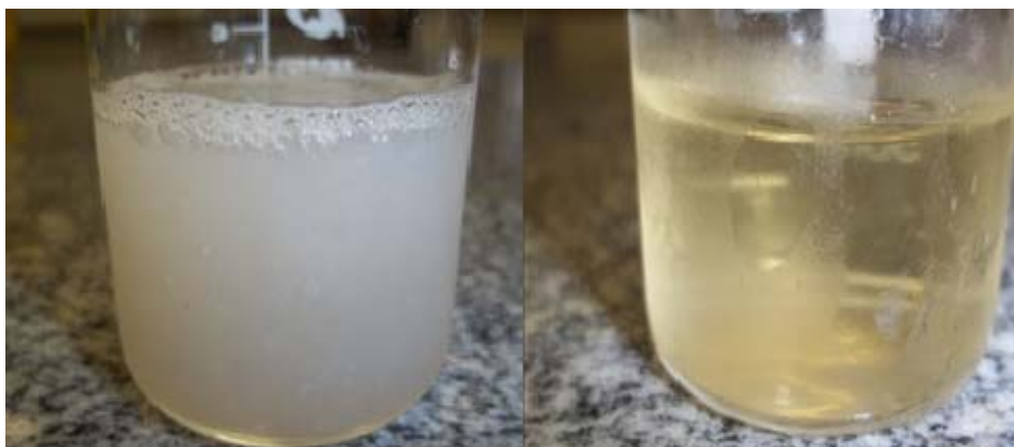
Figura 11 - Efluente de tintura bruto antes e após filtragem.
