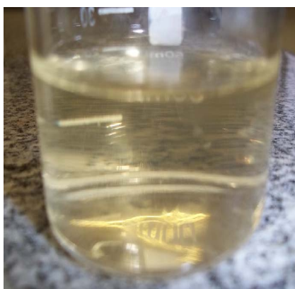
Figura 12 - Efluente bruto após o tratamento de foto-Fenton [Fe^{+2}] = 10 \text{ mg L}^{-1} e [H_2O_2] = 75 \text{ mg L}^{-1}
