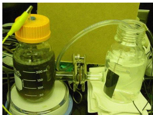
Fotografia 2 - CCM composta por câmara anódica anaeróbica (esquerda), câmara catódica aerada (direita) e membrana de Nafion.
