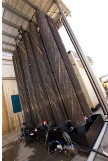
Fotografia 1 – Células combustíveis microbianas, implantadas em escala piloto, em cervejaria de Queensland, Austrália.
