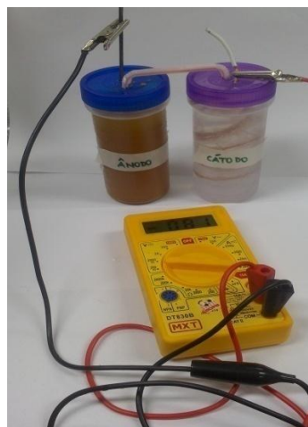
Fotografia 8 – CCM montada utilizando eletrodos de ferro fundido e grafite e meio lactato.
