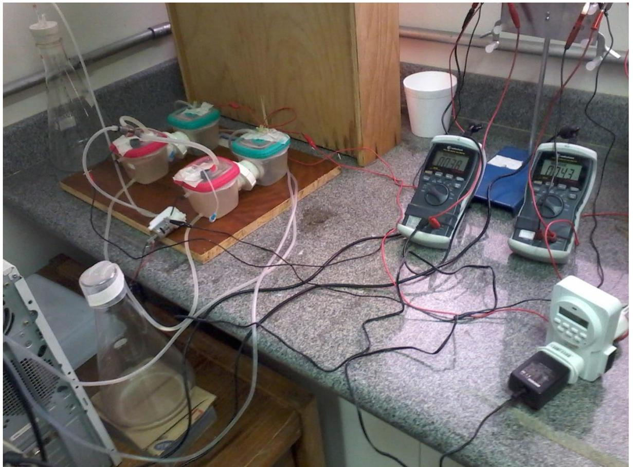
Figura 11. CCMs em sistema de alimentação intermitente de 350 mL em operação.
