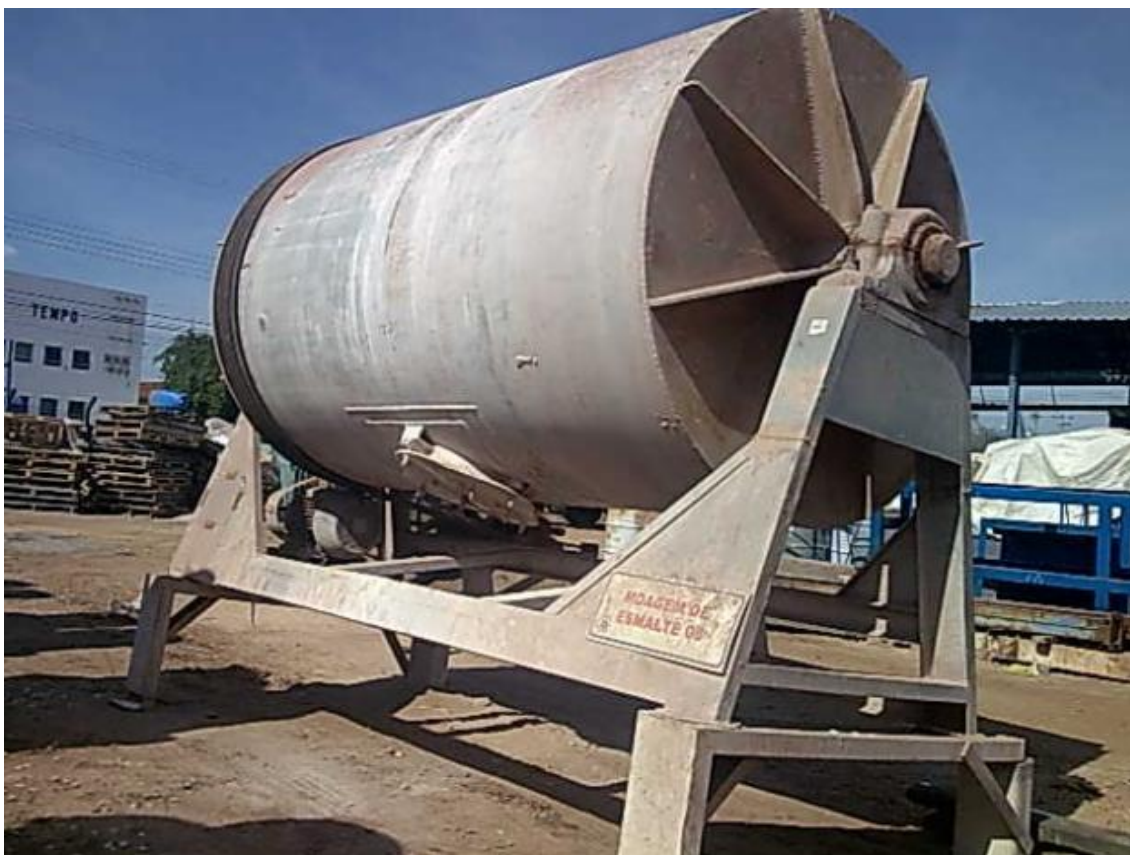
Figura 4 - Esquema de moinho de bolas. Fonte: SEMCO, 2002.
