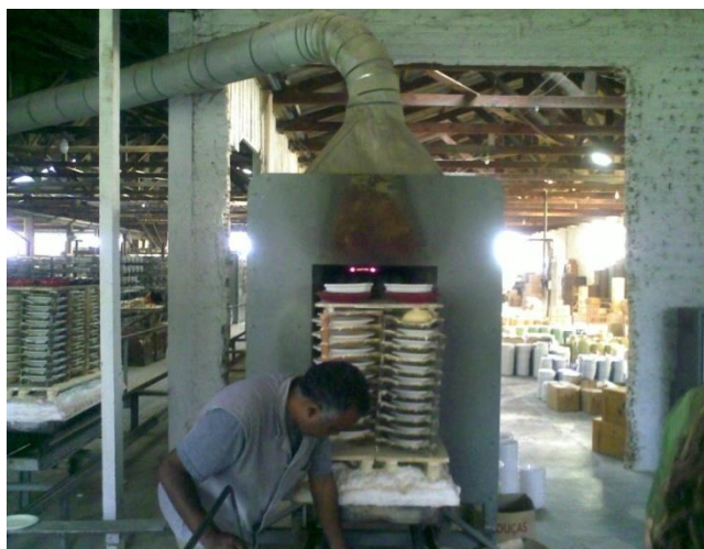
Figura 5 - Alimentação de cerâmica no forno cerâmico tipo túnel.
