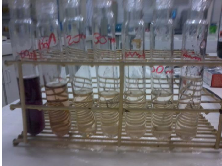
Figura 20: Alíquotas da corrida de degradação da amostra utilizando 1 grama de pérola, concentração 0,5 g \text{TiO}_2 , com a adição de 50 \mu\text{l} peróxido de hidrogênio. Da esquerda para a direita: Amostra com a solução (branco), amostra com a solução após 10, 20, 30, 40, 50 e 60 min de análise, respectivamente.
