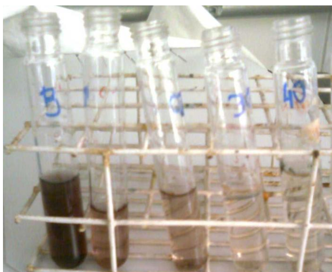
Figura 23: Alíquotas da corrida de degradação da amostra utilizando 3 gramas de pérola, concentração 5,0 g \text{TiO}_2 , com a adição de 30 \mu\text{L} peróxido de hidrogênio. Da esquerda para a direita: amostra com a solução (branco), amostra com a solução após 10, 20, 30 e 40 min de análise, respectivamente.
