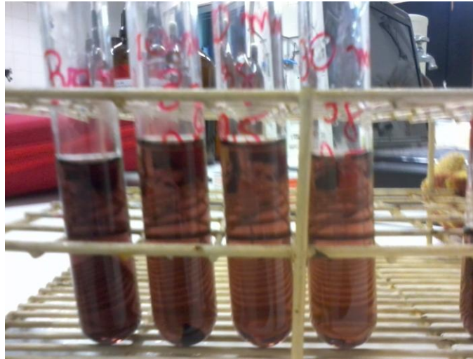
Figura 19: Alíquotas da corrida de degradação da amostra utilizando 3 gramas de pérola, concentração 5,0 g \text{TiO}_2 , sem a adição de peróxido de hidrogênio. Da esquerda para a direita: amostra com a solução (branco), amostra com a solução após 10 min de análise, amostra com a solução após 20 min de análise, amostra com a solução após 30 min de análise.
