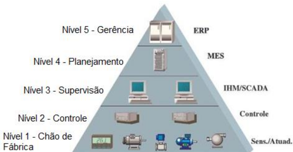
Figura 11 - Pirâmide Automação. Fonte: Adaptado de Coelho (2009, p.3).
