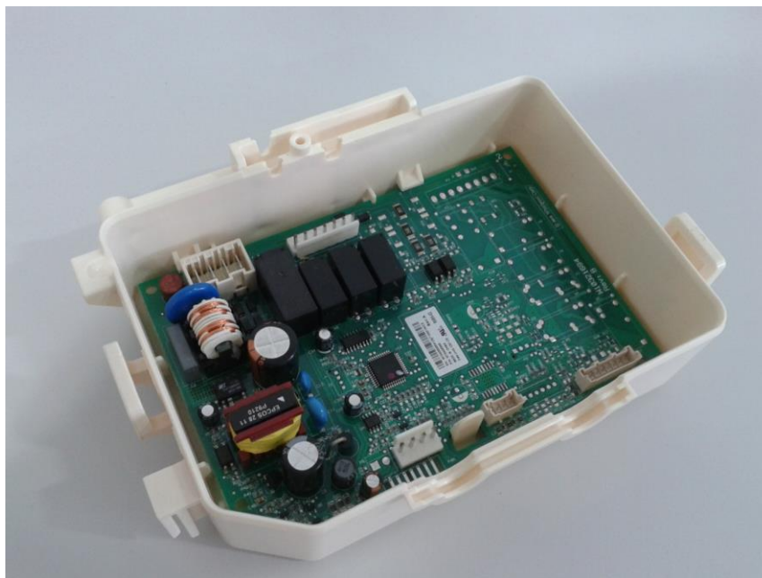
Figura 44 - Placa de Controle de Refrigeração PCR. Fonte: Autoria própria.
