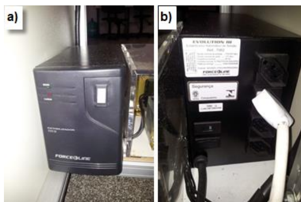
Figura 26 - Estabilizador Forceline. a) Vista frontal e b) Vista posterior. Fonte: Autoria própria.
