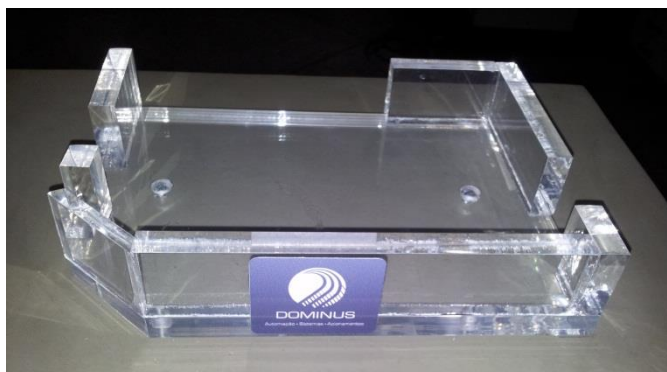
Figura 16 - Suporte acrílico placa PCR. Fonte: Autoria própria.
