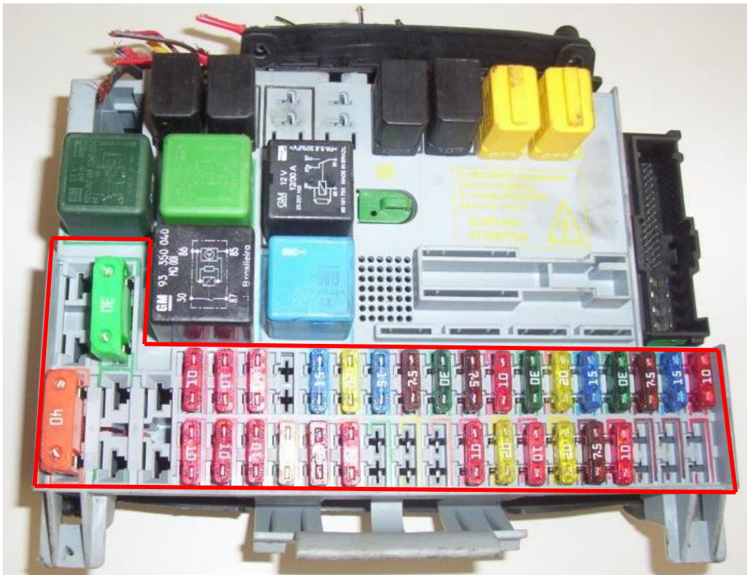
Figura 6 - Caixa de fusíveis do automóvel GM Chevrolet Astra GL Fonte: Autoria própria.
