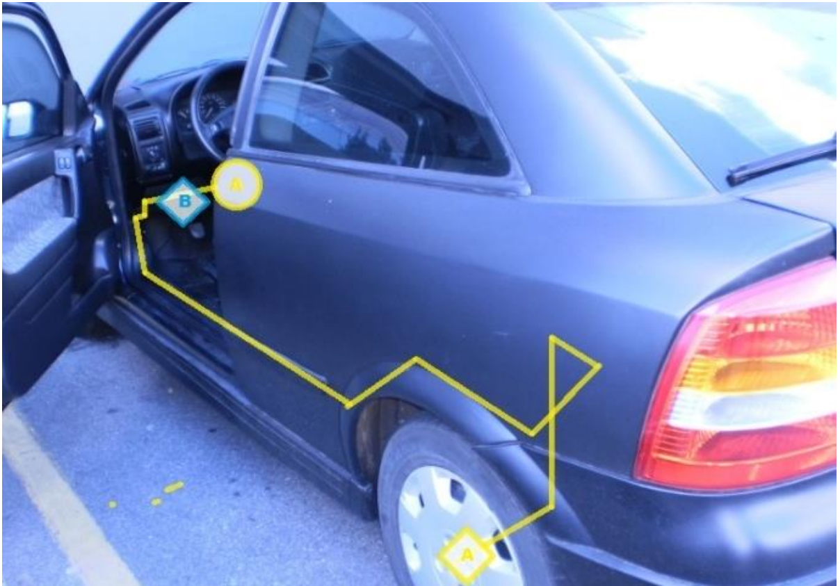
Figura 47 - Conexão do encoder da roda traseira (geral) Fonte: Autoria própria.
