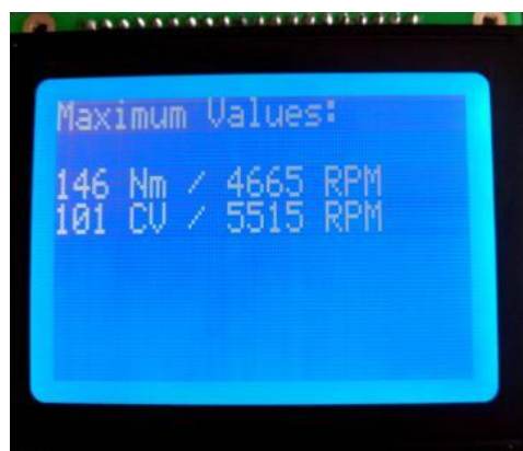
Figura 58 - Valores máximos de torque e de potência do dinamômetro de bordo Fonte: Autoria própria.
