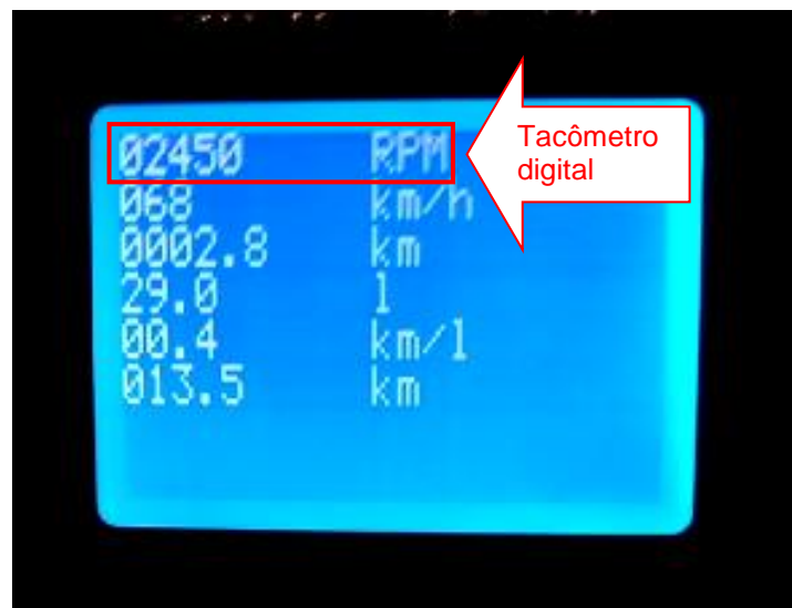
Figura 54 - Tacômetro final Fonte: Autoria própria.
