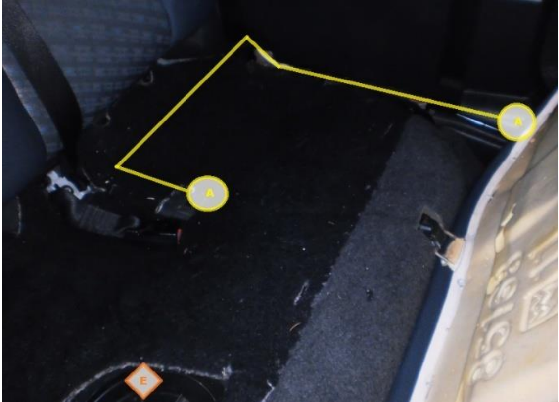
Figura 46 - Conexões do encoder da roda traseira Fonte: Autoria própria.
