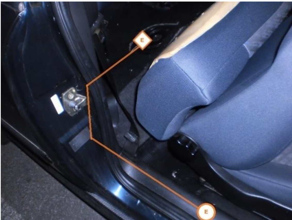
Figura 45 - Conexão do sensor do tanque de combustível Fonte: Autoria própria.
