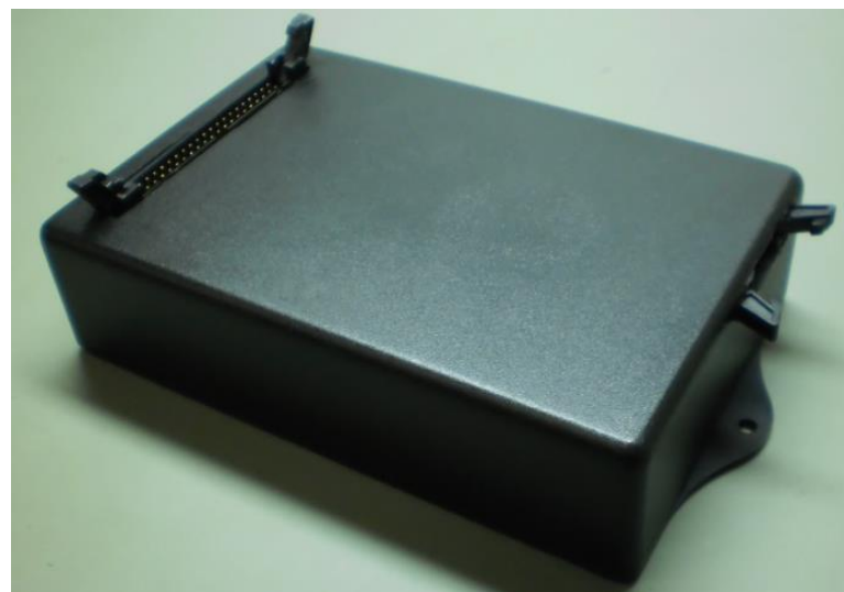
Figura 29 - Gabinete final da matriz de monitoramento dos fusíveis Fonte: Autoria própria.
