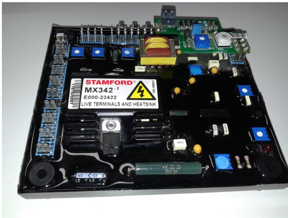
Figura 9 - Regulador Analógico de tensão Stamford – MX342 Fonte: Autoria própria.
