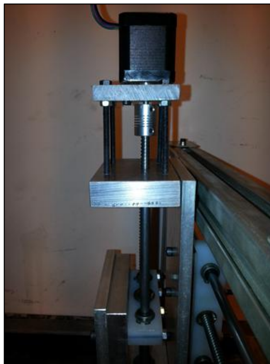
Figura 26 – Detalhe do acoplamento utilizado para os motores Fonte: Autoria própria
