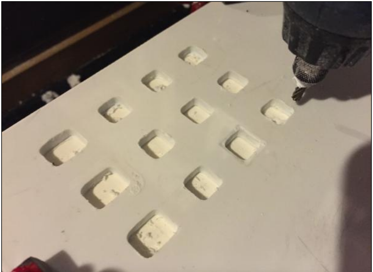
Figura 40 – Painel após usinagem na fresadora CNC Fonte: Autoria própria
