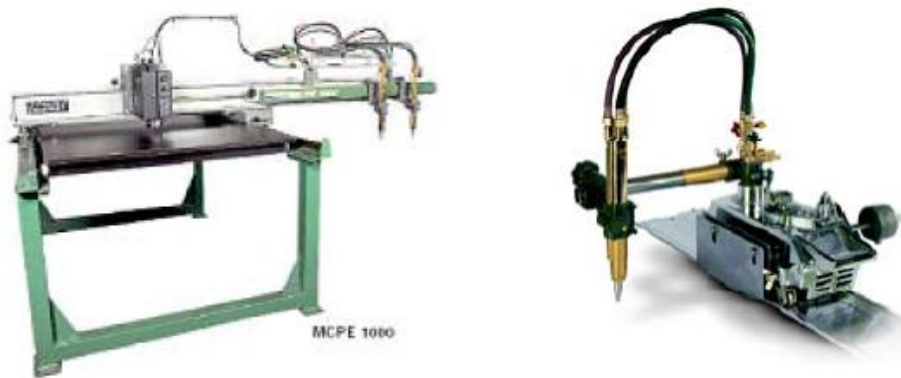
Figura 4: Máquina pantográfica e tartaruga para oxicorte Fonte: Adaptada de CARDIA, SOLCI (2013).
