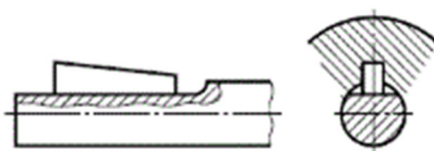
Figura 18 - Chaveta plana Fonte: Gordo; Ferreira (1995, p. 13).
