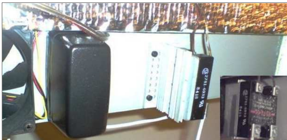
Figura 26– Relé de estado sólido fixado na face traseira do protótipo. Fonte: Autoria própria.
