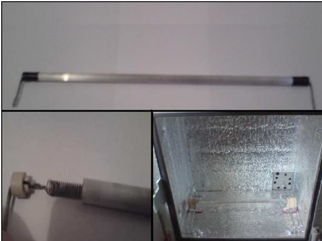
Figura 20 – Resistência utilizada no protótipo e detalhe de um dos terminais de conexão. Fonte: Autoria própria.
