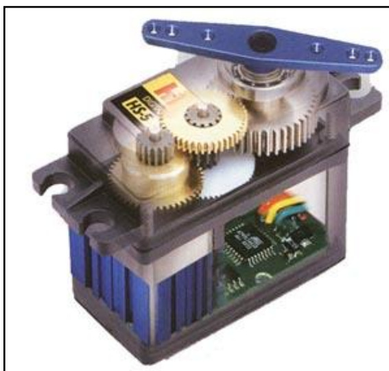
Figura 5 - Servo-motor controlado por PWM Fonte: Pyroeleetro (2012)
