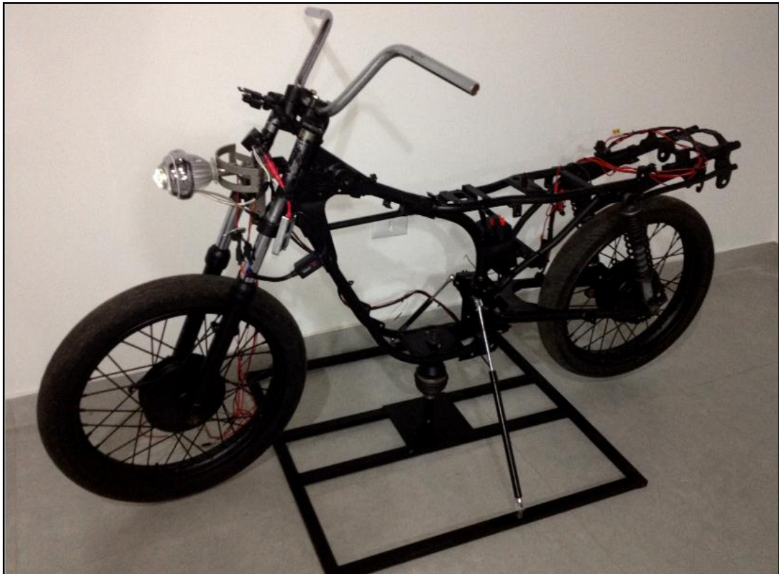
Figura 13 - Protótipo de simulação com o Sistema de Iluminação Inteligente Fonte: Autoria própria
