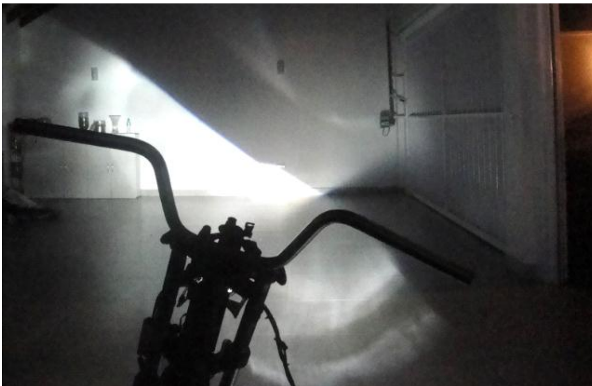
Figura 30 - Teste 2 - Inclinação de 30 graus para direita com o sistema desligado Fonte: Autoria própria
