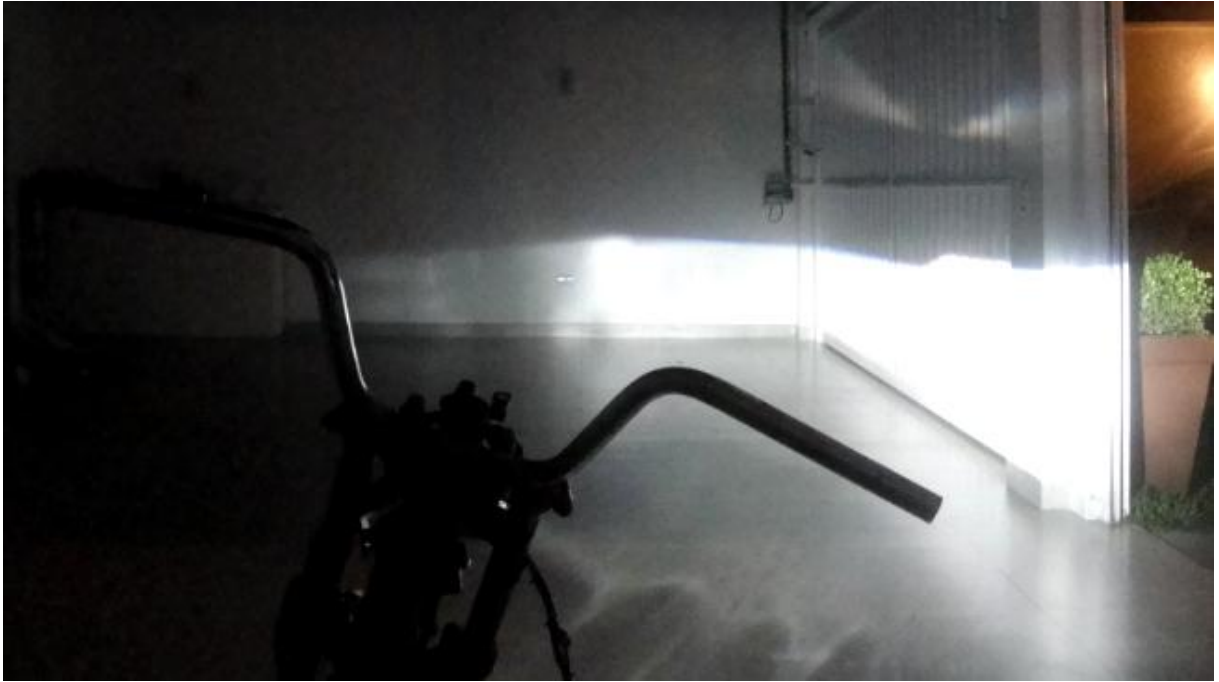
Figura 31 - Teste 3 - Inclinação de 30 graus para direita com o sistema ligado Fonte: Autoria própria
