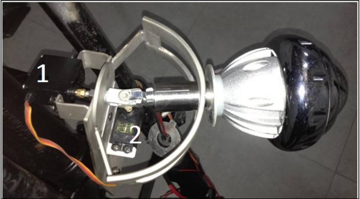
Figura 14 - Mecânica de movimentação do farol inteligente. Fonte: Autoria própria
