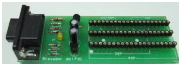
Figura 28 – Foto do gravador de PIC EDUTECHKITS Fonte: Autoria própria.
