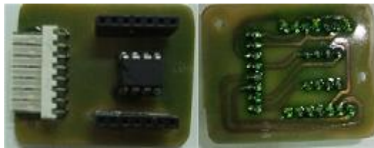
Figura 36 – Fotos do circuito acelerômetro mão finalizado Fonte: Autoria própria.
