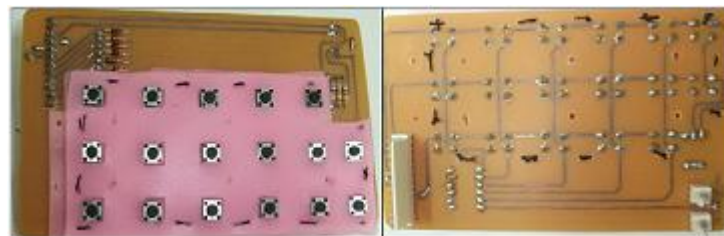
Figura 46 – Fotos do circuito teclado controle finalizado Fonte: Autoria própria.
